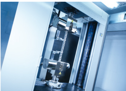
Bruchkraftermittlung und Dehnungsaufnahmen bis 1000 kN
