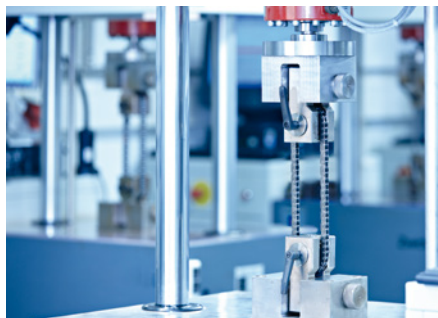
Dauerfestigkeits- und Zeitfestigkeitsüberprüfungen durch mehr als 25 Pulsatoren nach unterschiedlichen Prüfverfahren
