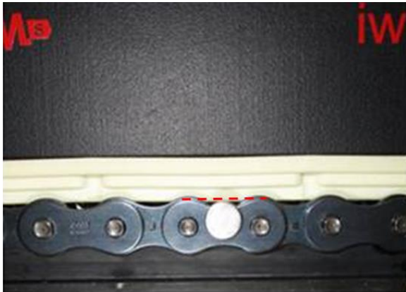
Magnet wird bündig mit der Oberkante der Außenlasche montiert
