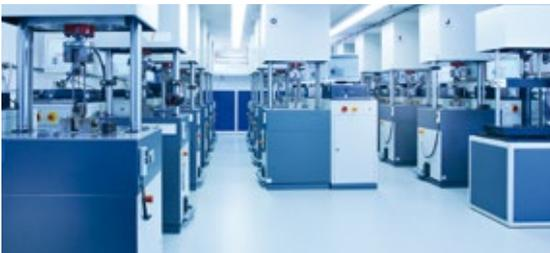
Es stehen mehr als 21 Impulsgeber (weltweit) zur Prüfung der dynamischen Dauerfestigkeit anhand verschiedener Testmethoden zur Verfügung
