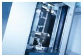
Beurteilung der Kettenbruchkraft und -länge bis 1000 kN
