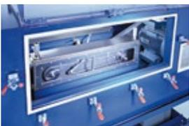
Untersuchung der Kettenverschleißlänge auf mehr als 20 Prüfständen
