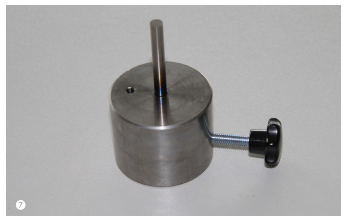
Stifthalter mit Halteschraube Tool holder with drive pin
