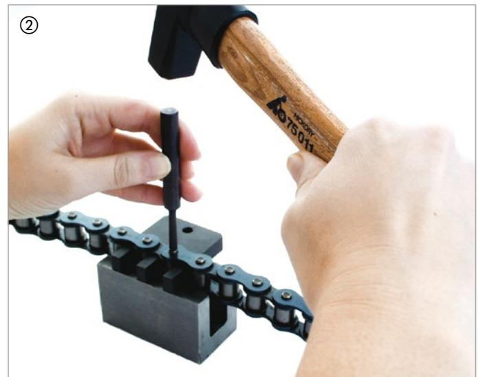
Man steckt den vorstehenden Bolzen in die entsprechende Büchse der Nietplatte und schlägt ihn mit dem Hammer so weit hinein, bis er nicht mehr übersteht. Mit einem Durchschlag wird dann der Bolzen ganz ausgeschlagen ①. Bei schweren Ketten (über 3/4") ist es vorteilhaft, den Nietkopf vorher abzuschleifen.
