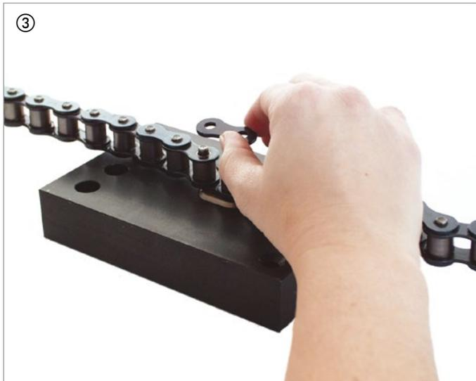
Die Verfahrensweise ist bei Ketten mit abgesetzten Bolzen die gleiche, wie bei Ketten mit glatten Bolzen. Man steckt einen neuen Stiftblock in die zwei Kettenenden, legt die Kette auf das Einsatzstück der Nietplatte und drückt eine neue Außenlasche auf die Nietenden des Stiftblocks ③.
