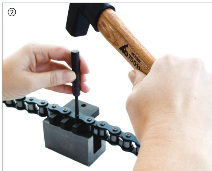
Introduisez l'axe dans la douille de la plaque à riveter et frappez l'axe à l'aide d'un marteau tant qu'il fait saillie. Chassez l'axe d'une percussion **1**. En présence de chaînes lourdes (supérieures à 3/4"), il est judicieux de meuler la tête de rivet auparavant.
