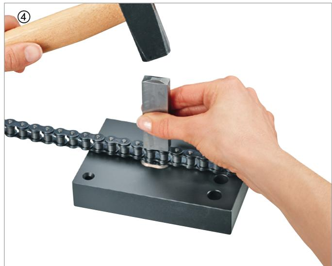
La procédure est la même qu'il s'agisse de chaîne à axes lisses ou à axes épaulés. Enfilez un jeu neuf composé de deux plaques extérieures et de deux rivets dans les deux extrémités de la chaîne, placez la chaîne sur l'insert de la plaque à riveter et appliquez une plaque extérieure neuve sur les extrémités des rivets du jeu ③.
